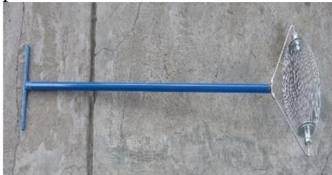
Gambar 1. Rancangan Alat Pengumpul Brondolan Buah Sawit
